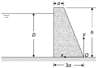
A figura mostra a seção transversal de uma barragem de gravidade projetada para suportar uma lâmina d'água de altura  $D$ . Sabe-se que não há infiltração de água entre o solo e a barragem. São dados os pesos por unidade de volume da água,  $\gamma_a$ , e do material da barragem,  $\gamma_c$ . É dada, também, a largura  $L$  da barragem (perpendicular ao plano da figura). Pedem-se:
