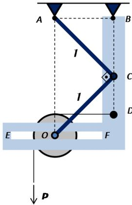
A estrutura da figura é composta por um suporte em “L”, pelas barras AC e OC de comprimento  $l$  e pela polia de raio  $R$  e centro O. A barra OC e a polia estão conectadas por um pino que pode deslizar sem atrito na guia EF; as barras AC e OC estão articuladas ao pino C, que é parafusado ao suporte. O fio está preso ao pino D e sustenta uma carga  $P$ . Considerando  $R = l \frac{\sqrt{2}}{4}$  e todos os pesos desprezíveis, pedem-se:
