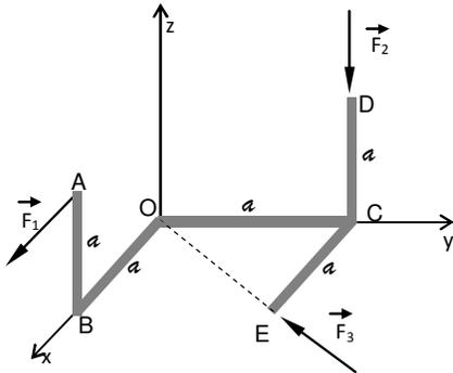
A peça  $ABCDE$  é formada por cinco barras rígidas soldadas e submetida ao sistema de forças  $S: (\vec{F}_1, A), (\vec{F}_2, D)$  e  $(\vec{F}_3, E)$ .
