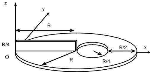
circular de raio  $R$  que possui um furo de raio  $R/4$  na posição apresentada na figura. O sistema possui ainda uma nervura vertical soldada de comprimento  $R$  e altura  $R/4$ . Considere o sistema de coordenadas  $Oxyz$ . As chapas têm espessura desprezível e são feitas de material homogêneo com densidade de área  $\rho$ .
