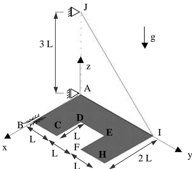
A placa homogênea ABCDEFHI de peso  $P$  é suportada por uma articulação em A, por um anel em B e por um fio ideal em I no plano  $Ayz$ . Determine:
