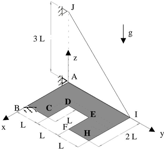
A placa homogênea ABCDEFHI de peso  $P$  é suportado por uma articulação em A, por um anel em B e por um fio ideal em I. O fio está no plano  $Ayz$ . Determine:
