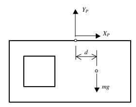
Do equilíbrio é imediato que  $X_P = 0$ ,  $Y_P = mg$ , e da equação de equilíbrio de momentos, "d" deve ser igual a zero, isto é, o baricentro deve estar posicionado verticalmente abaixo da articulação P. Adotando-se um sistema de coordenadas com origem no vértice inferior esquerdo da placa deve-se então ter:
