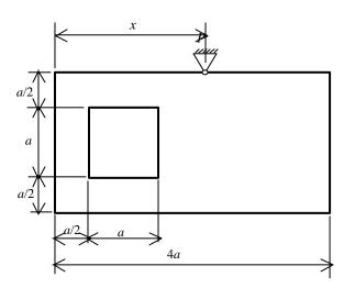
**Questão 2 (2,0 pontos)** — Uma placa retangular homogênea de lados 4a e 2a, e massa m, tem um furo quadrado de lado a, conforme mostra a figura ao lado. Esta placa é suportada por uma articulação em P. A que distância x da extremidade deve ser posicionada a articulação para a placa se equilibrar na posição indicada na figura sob a ação da gravidade?
