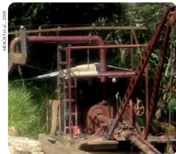
Figura 14 – Equipamentos utilizados na extração de areia ("areiais") do leito do rio Paraíba do Sul e afluentes.
