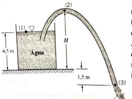
11. (Young, Munson, Okiishi. Ex 3.10) A figura ao lado mostra o modo de retirar água a 20° C de um grande tanque. Sabendo que o diâmetro da mangueira é constante, determine a máxima elevação da mangueira, H, para que não ocorra cavitação no escoamento da água da mangueira. Admita que a secção de descarga d mangueira está localizada a 1,5 m abaixo da superfície inferior do tanque e que a pressão atmosférica é igual a 1,03 bar (abs).
