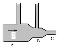
Pelo visto em pressão em manômetros, a pressão atmosférica, na superfície livre do liquido no tubo em A é P0. Conhecida a pressão manométrica dentro da tubulação, PmA = 1,22 atm = 1,22·1,013·105=1,24.105 N/m<sup>2</sup>.
