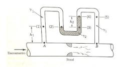
**9.** (Young, Munson, Okiishi) A figura ao lado mostra o esboço de um dispositivo utilizado para medir a vazão em tubos, Q. O bocal convergente cria uma queda de pressão  $p_A - p_B$  no escoamento, que está relacionada com a vazão em
