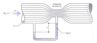
garganta são, respectivamente, de  $20~\text{cm}^2$  e  $10~\text{cm}^2$ . Admitir que o peso específico da água  $\gamma_{\text{água}} = 9810~\text{kg.m}^{-3}$  e  $\gamma_{\text{ar}} = 11,77~\text{kg.m}^{-3}$ .
