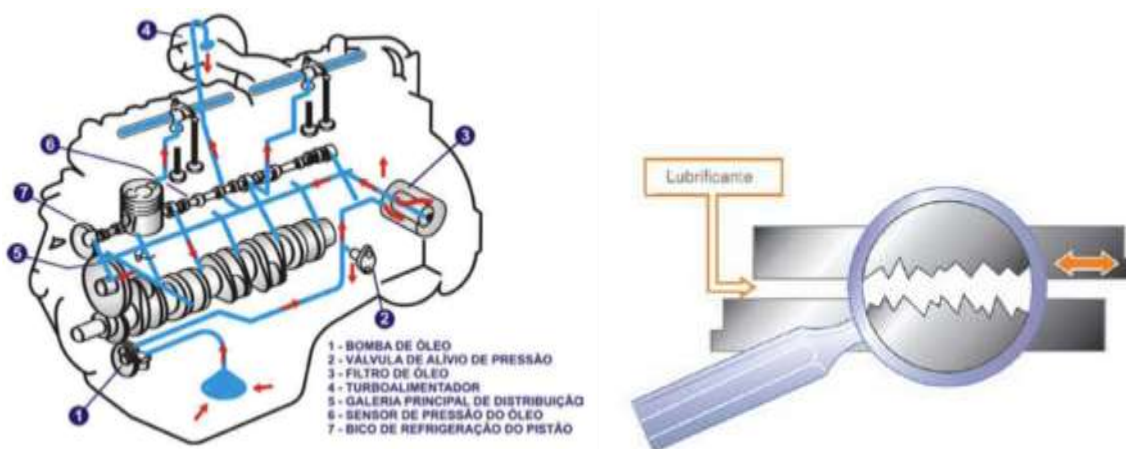
Figura 10 – Na esquerda diagrama do sistema de lubrificação de um motor e à direita representação do atrito na interação de partes móveis entre as quais deve ser utilizado lubrificante para reduzir desgaste e consumo de energia. Fonte: SENAR (2010).
