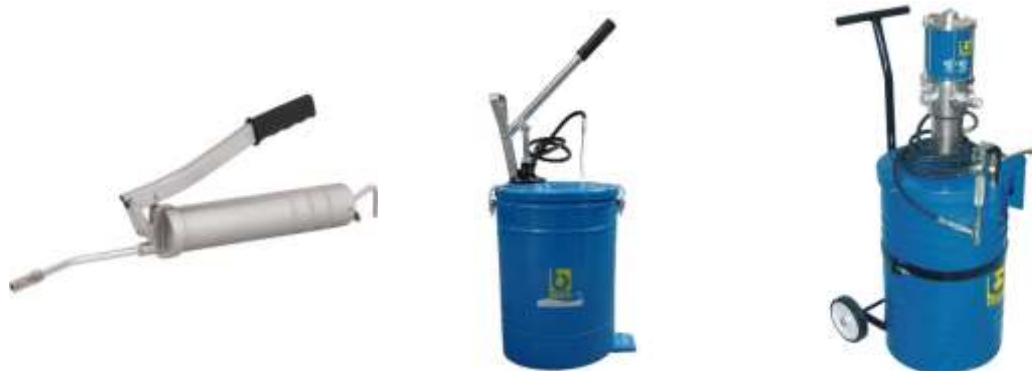
Figura 14 – Alguns exemplos de lubrificadores, da esquerda para a direita engraxadora manual portátil, engraxadora com compartimento e mangueira e engraxadora com sistema pneumático.
