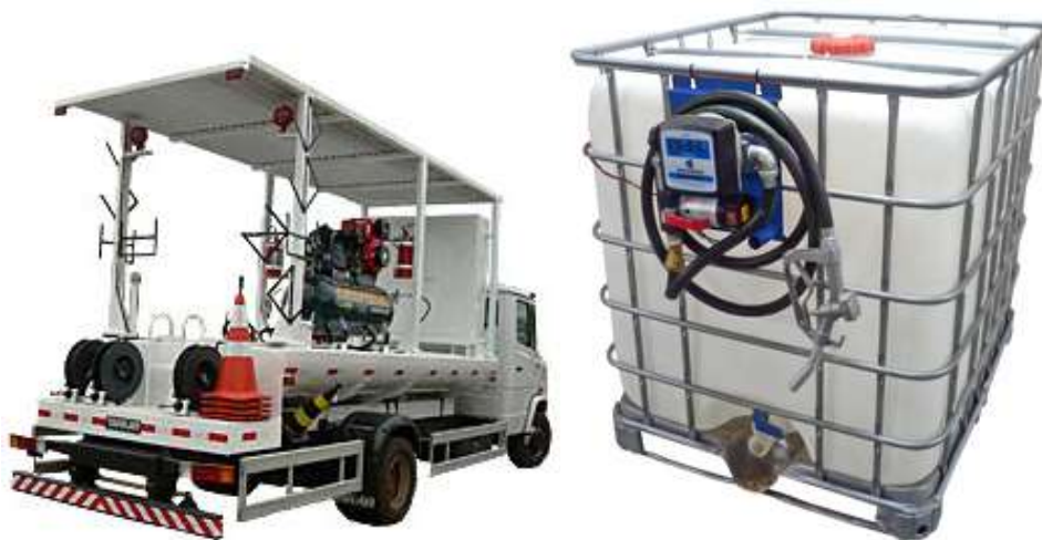
Figura 12 – Na esquerda caminhão comboio para lubrificação de máquinas em campo, na direita reservatório com bomba para óleo hidráulico que pode ser levado a campo para trocas rápidas, estas bombas permitem controle da quantidade de óleo aplicado.
