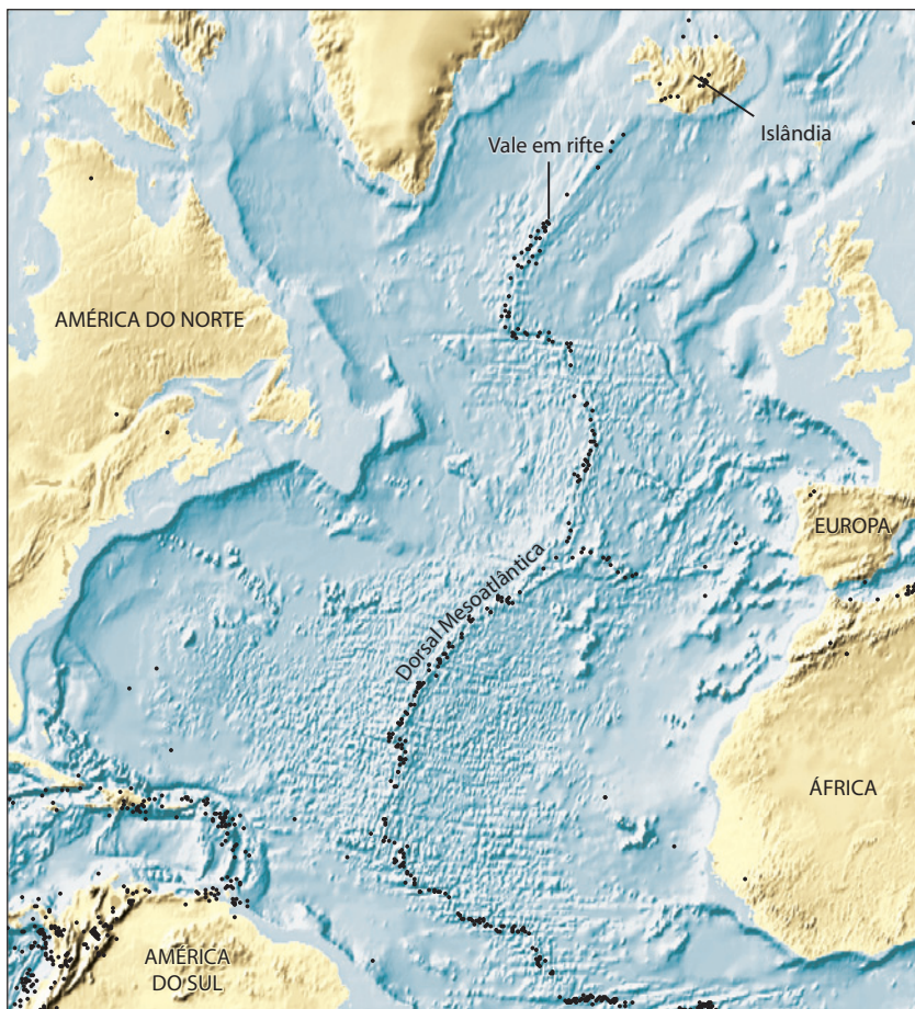
FIGURA 2.4 ■ O assoalho oceânico do Atlântico Norte, mostrando os vales em rifte em forma de fendas ao longo do centro da Dorsal Mesoatlântica e os terremotos associados (pontos pretos).
