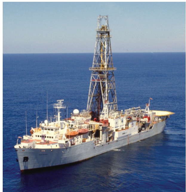
FIGURA 2.13 ■ O navio JOIDES Resolution , que perfura em mar profundo, tem 143 m de comprimento e carrega uma torre de perfuração de 61 m de altura, com capacidade de perfurar até o oceano mais profundo. Amostras de rocha recuperadas do assoalho oceânico confirmaram as idades de rochas do fundo oceânico deduzidas a partir de anomalias magnéticas. Essas amostras também lançaram nova luz sobre a história das bacias oceânicas e as antigas condições climáticas. [Cortesia do Programa de Perfuração Oceânica/TAMU]
