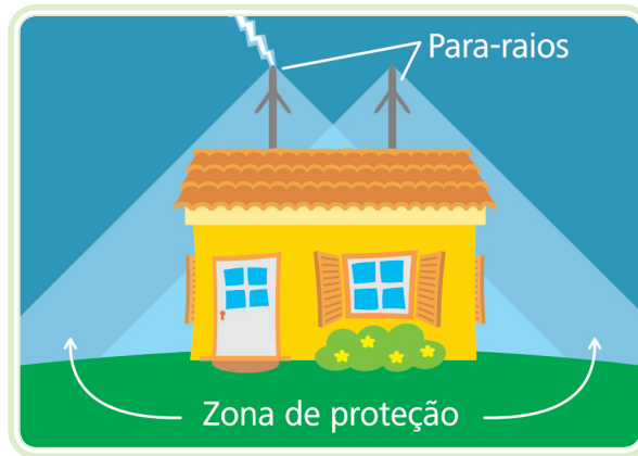
Figura 1.11: Aplicação de para-raios
