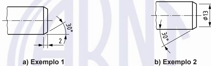
Figura B.1 – Cotagem para chanfros externos
