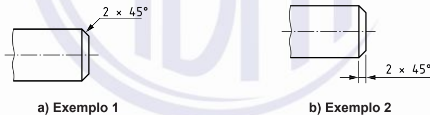
Figura B.2 – Cotagem simplificada para chanfros externos
