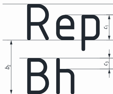
Figura 34 – Espaçamento entre linhas de base ( b_2 ), utilizando letras maiúsculas e minúsculas sem sinais diacríticos
