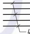
Figura 26 – Exemplo de uma linha de referência com um comprimento fixo para uma dimensão
