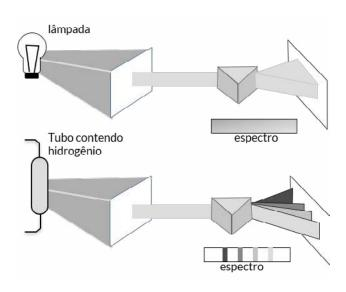
Ao passar por um prisma, essa luz se subdividia em diferentes comprimentos de onda e frequência, caracterizando um **ESPECTRO LUMINOSO DESCONTÍNUO**.
