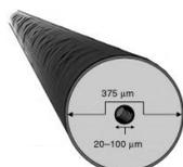
Revestimento de poliimida (5  $\mu\text{m}$ )
