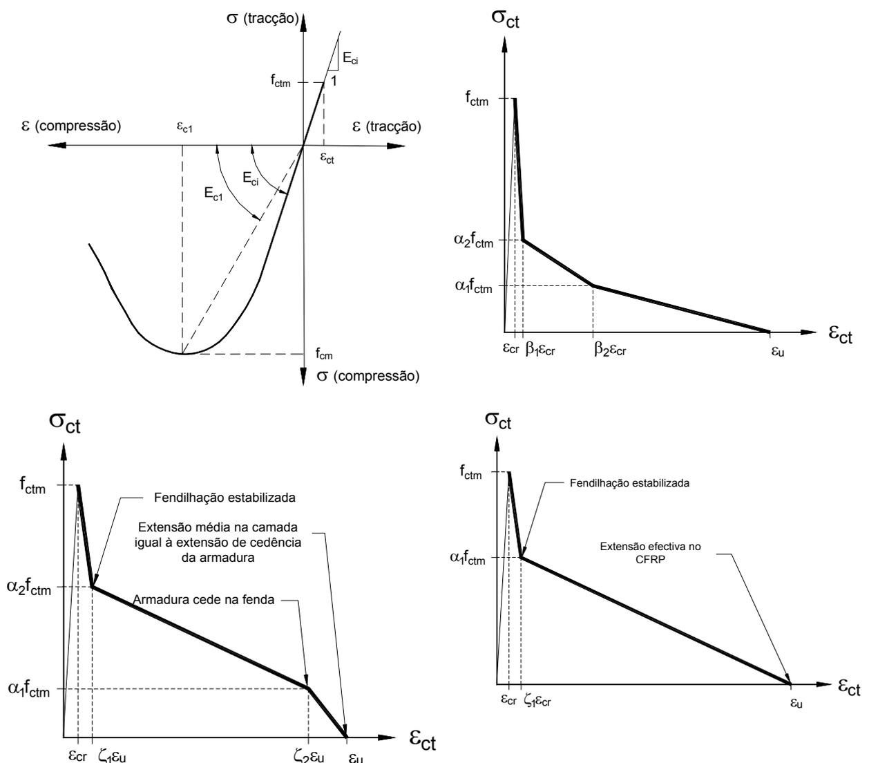
Figura 10 - Diagramas utilizados na simulação do comportamento do betão: (a) à compressão; (b) amolecimento em tracção (softening); (c) endurecimento em tracção nas vigas de referência (stiffening); (d) endurecimento em tracção nas vigas reforçadas (stiffening)
