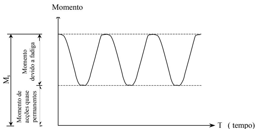
Figura 2 – Ilustração do nível de momento aplicado a ser usado na verificação da tensão limite no FRP.
