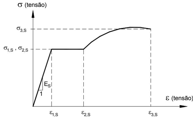
Figura 11 - Lei tensão-extensão para o aço.
