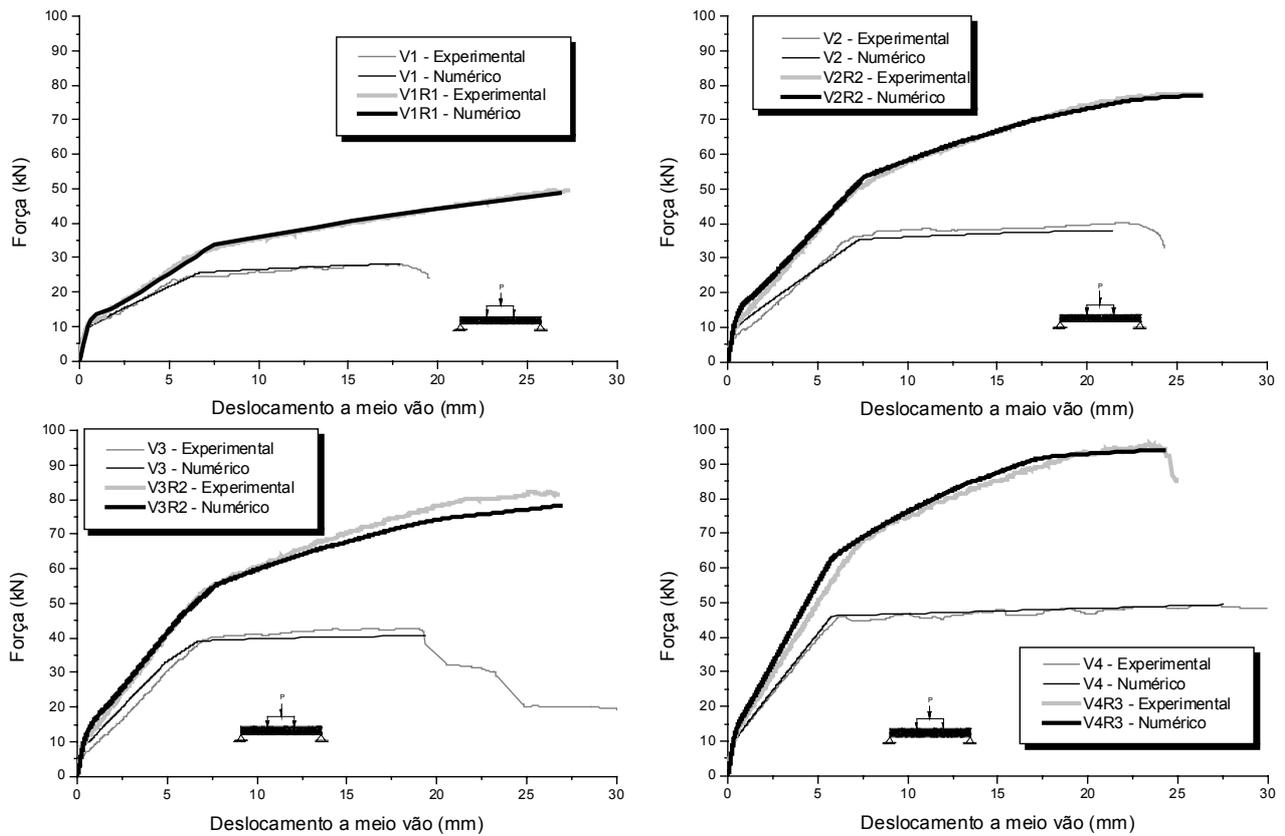
Figura 12 - Força-flecha experimental e numérico.
