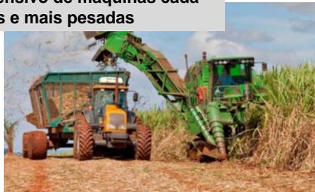
Tráfego de máquinas com umidade inadequada do solo (muito úmido)
