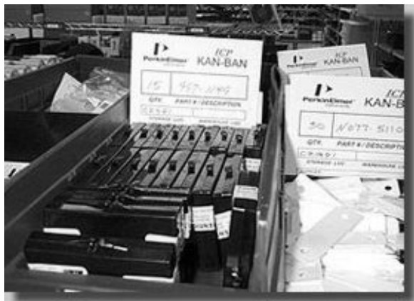
FIGURA 7.4 Exemplo de cartão Kanban usado para “puxar” a produção em sistemas Just in Time .
