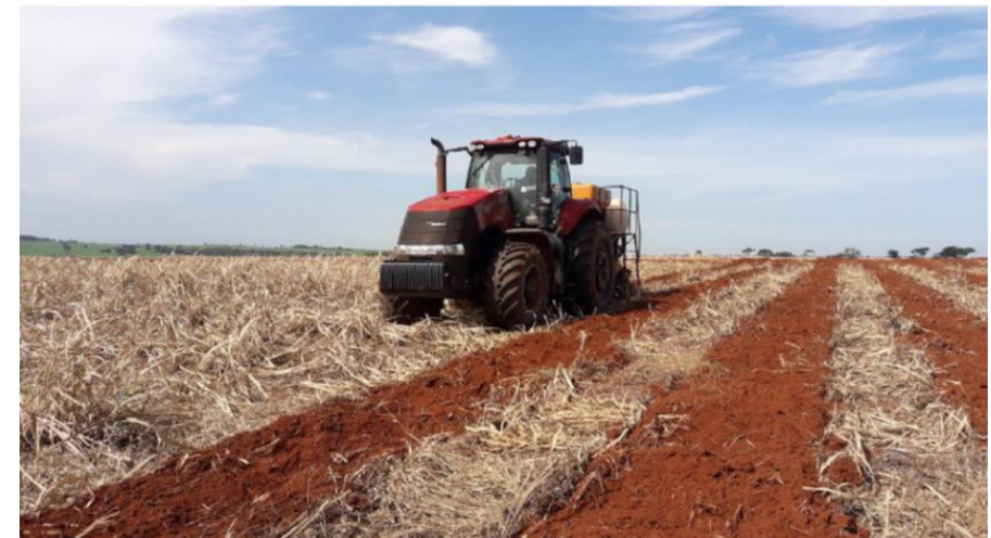
Canteirizador em espaçamento duplo alternado (0,90 m x 1,40 m)
