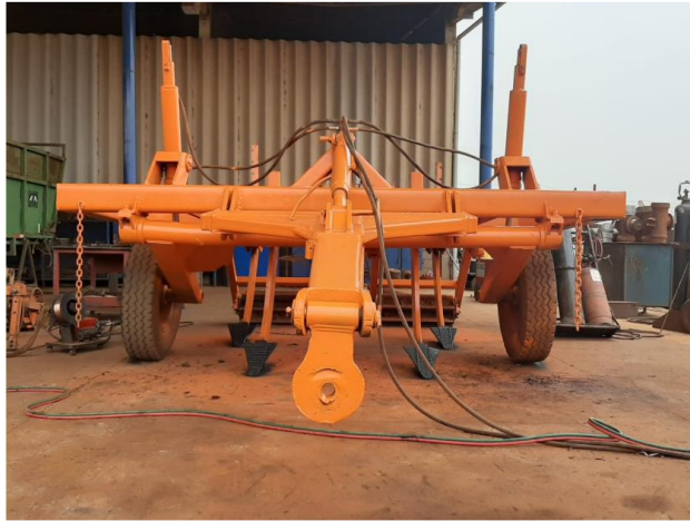
Disposição geométrica de subsolador de 4 hastes para preparo localizado
