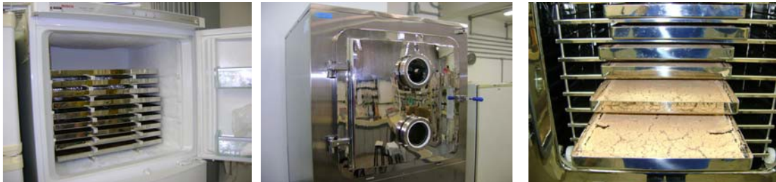
Figura AI.3. Processo de liofilização das amostras de feijão OGM e comum, previamente cozidas e homogeneizadas.
