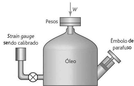
Figura 6.30 Calibração de peso morto para medidores de pressão.
