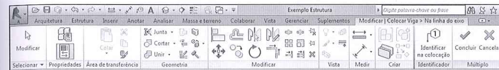
Figura 10.54 – Aba Modificar | Colocar Pilar estrutural – seleção de Concluir após a escolha dos eixos.
