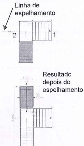
Figura 11.85 – Espelhamento de um trecho da escada.
