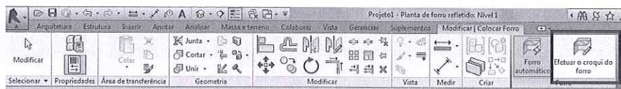
Figura 9.68 – Seleção de Efetuar o croqui do forro para desenhar o forro de forma livre.
