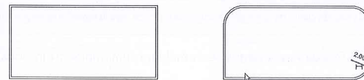
Figura 5.107 – Paredes com cantos arredondados.
