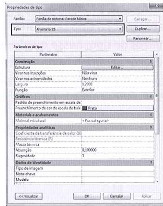
Figura 5.38 – Propriedades da parede "Alvenaria 25" a serem alteradas.
