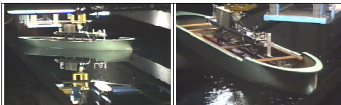
**Figura 4.8 – Visualização de ensaio de *yaw-rotating* conduzido na DITT/IPT e do aparato experimental. Fotografias gentilmente cedidas pela Petrobras.**
