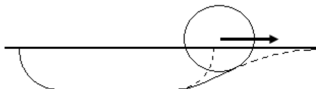
Figura 5.79 - Riser saindo da trincheira
