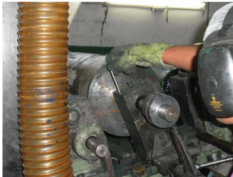
Figura 3.19 – Retirar parafusos dos mancais. Fonte: Próprio autor.
