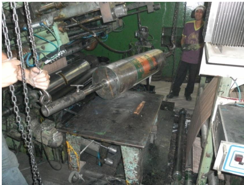
Figura 3.34 – Colocando o cilindro em cima do carrinho. Fonte: Próprio autor.
