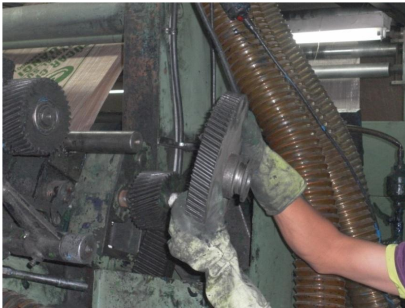
Figura 3.26 – Retirando as engrenagens. Fonte: Próprio autor.
