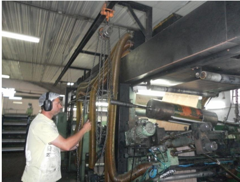
Figura 3.33 – Levantando o cilindro. Fonte: Próprio autor.
