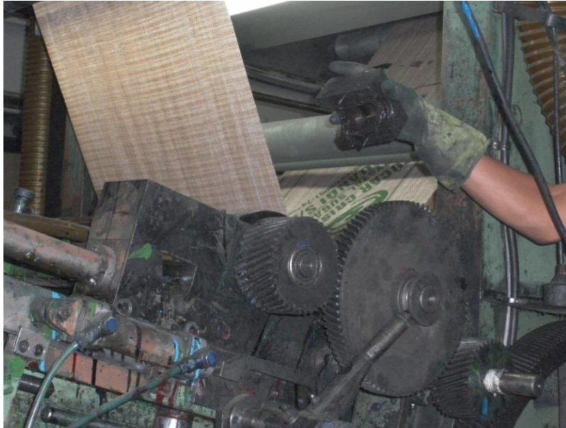
Figura 3.21 – Capa dos mancais. Fonte: Próprio autor.
