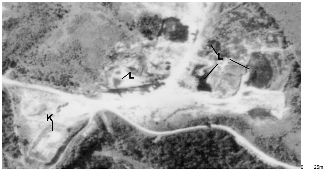
Fotoimagem 8: Em 1986, área de disposição de resíduos industriais líquidos (L), em tanques abertos nos solos ("borreiros") e resíduos industriais sólidos enterrados (K).
