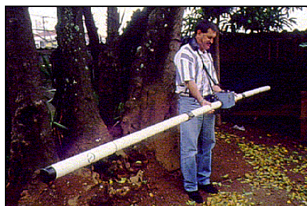
Figura 6200-3: Condutivímetro EM31 (prof. de investigação: 3 e 6m).
