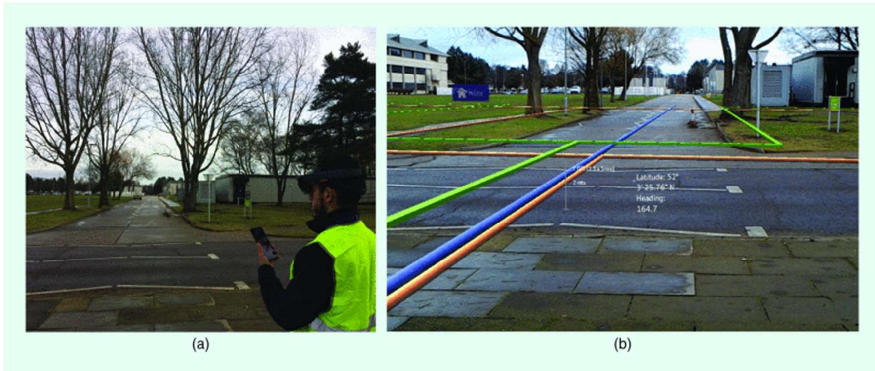
Figura: Um sistema de assistente imersivo inteligente. (a) Um engenheiro e (b) uma visão em primeira pessoa do aplicativo AR. Pena-Rios et al. (2018)
