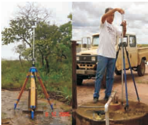
Figura 4.1.4 - Processo de nivelamento de poços utilizando DGPS: (a) calibração do equipamento utilizando um marco do IBGE; (b) medição do valor da cota da boca de um poço (CPRM/UFBA, 2008).
