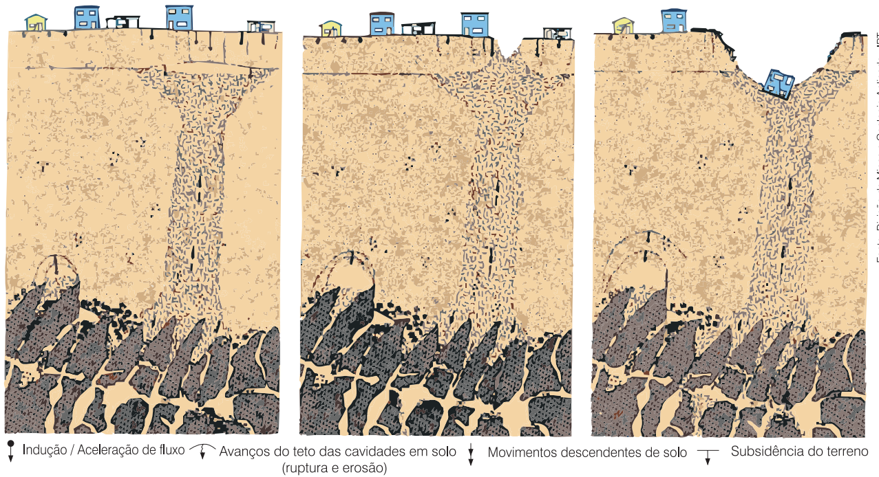
Figura 3.3.26 - Esquema do colapso em Lagamar / SP (modificado de IPT, 1988).
