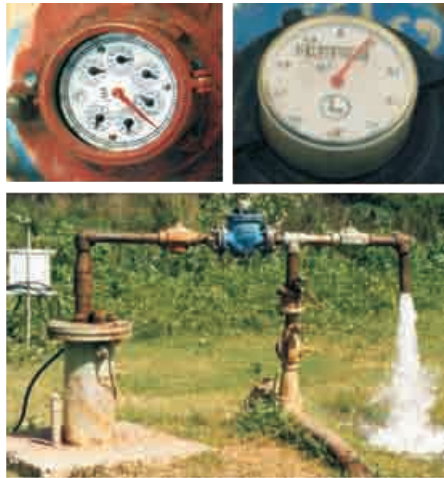
Figura 6.3.18 - Exemplos de hidrômetros e sua aplicação em testes de bombeamento (Fotos: Geilson Demetrio).
