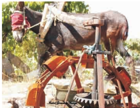
Figura 6.8.1 - Nora para bombeamento de poços (Foto: http://rebolosa.blogs.sapo.pt/39877.html ).
