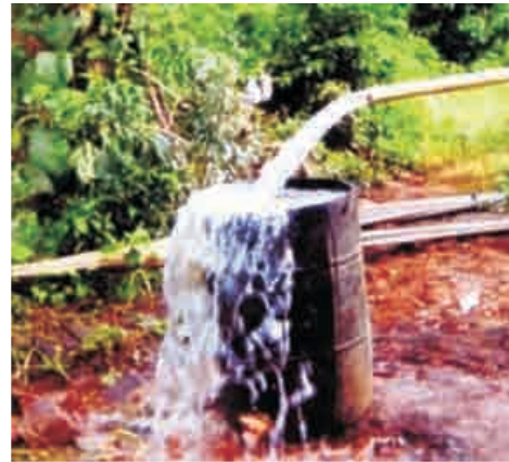
Figura 6.3.20 - Utilização do método volumétrico em teste de bombeamento (Foto: internet).
