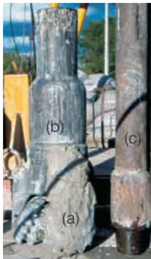
Figura 6.1.10 - (a) Broca tricônica; (b) sub-de-broca; (c) haste.
