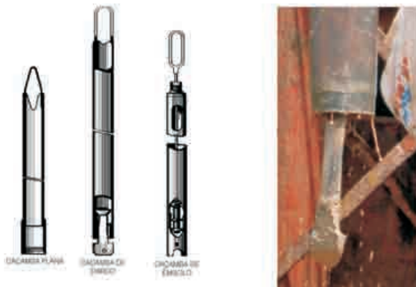
Figura 6.1.7 - Figuras esquemáticas de vários tipos de caçambas de limpeza (adaptado de Custodio & Llamas, 1983) e foto de uma caçamba de dardo.
