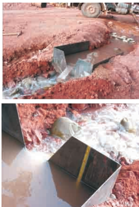
Figura 6.3.17 - Vertedouro triangular utilizado para medição de vazão em teste de produção preliminar durante a perfuração (Fotos: Geilson Demetrio).
