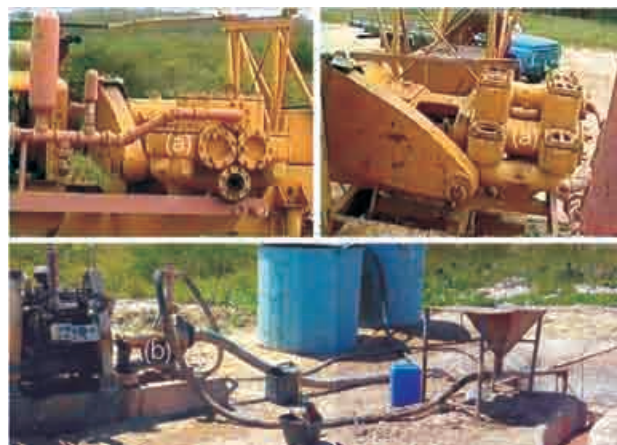
Figura 6.1.12 - Bombas de Lama: (a) bomba de pistão duplex; (b) bomba centrífuga.
