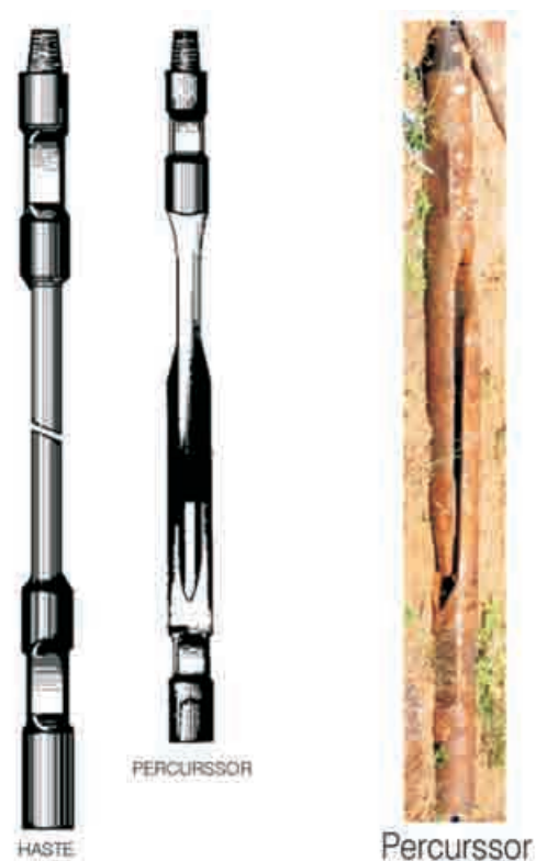
Figura 6.1.5 - Figuras ilustrativas de uma haste e um percussor (adaptado de Custodio & Llamas, 1983) e foto de um percussor.
