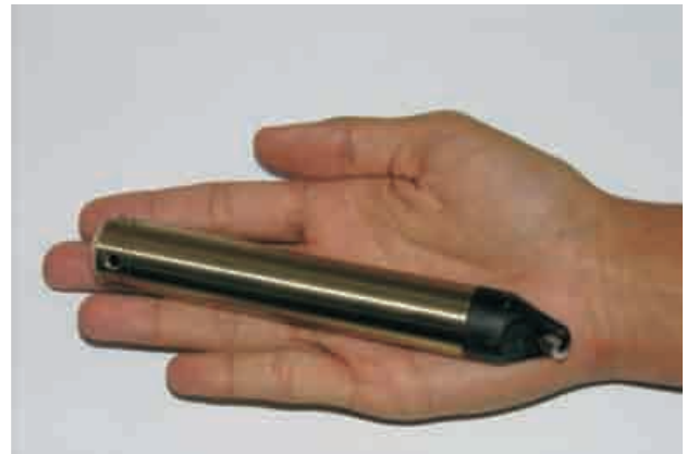
Figura 6.3.6 - Registrador de nível automático – Levelogger (Foto: Demetrio. J.G.A).
