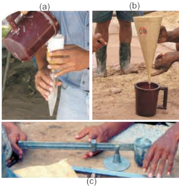
Figura 6.1.13 - Controle do fluido de perfuração: (a) teor de areia ; (b) viscosidade; (c) densidade.
