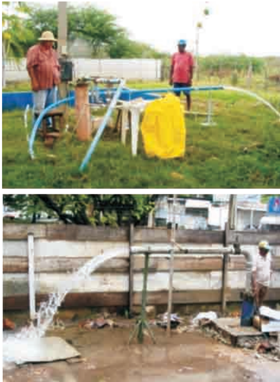
Figura 6.3.10 - Exemplos de testes de bombeamento utilizando escoadouro de orifício circular (Fotos: Geilson Demetrio).
