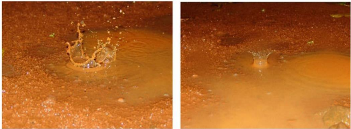
Figura 5 - Quando chove, gotas com até 6 mm de diâmetro bombardeiam a superfície do solo com velocidade de impacto de até 32 km/h. Essa força dispersa e joga partículas de solo e de água para todas as direções numa distância de até 1 m.
