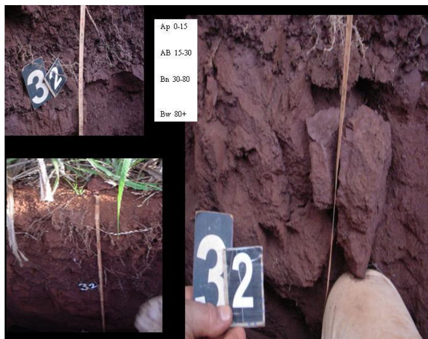
Compactação forte, com blocos grandes duros e raízes amassadas
