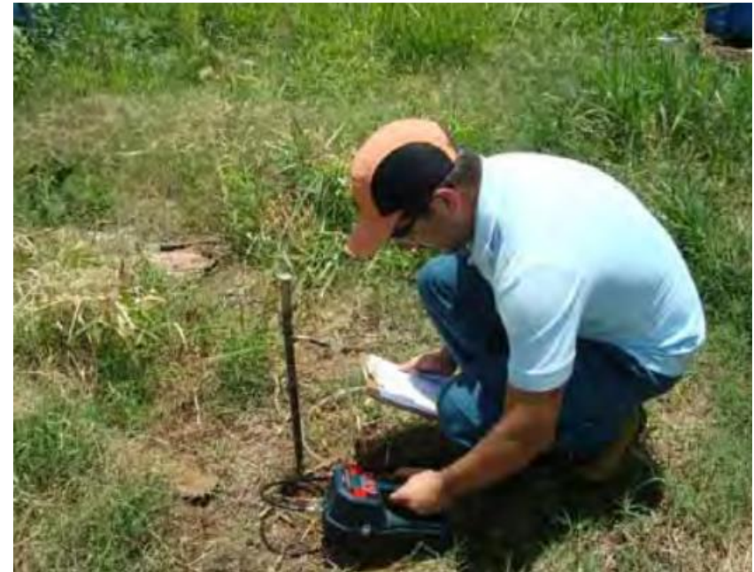
Mediação de gás utilizando Gastech Innova SV
