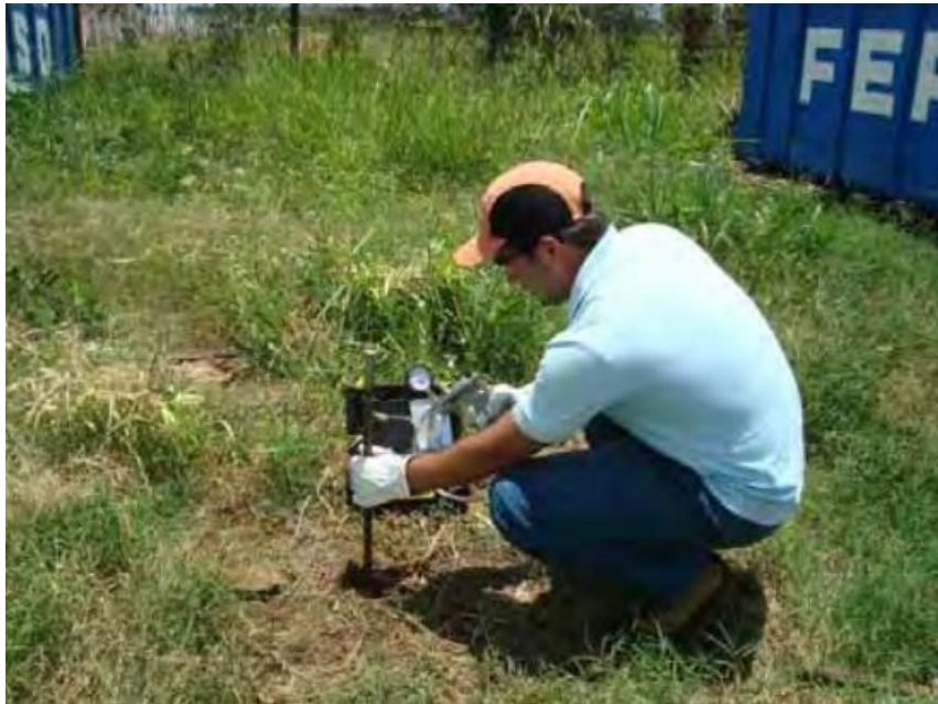
Purga utilizando bomba à vácuo manual.
