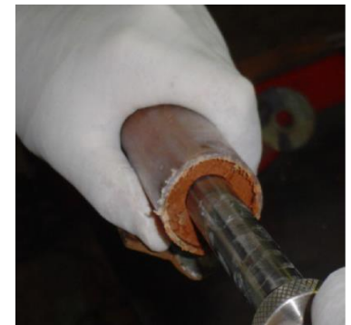
Coleta solo do liner usando En Core
