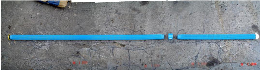
Tubo geomecânico ranhurado: revestimento + filtro
