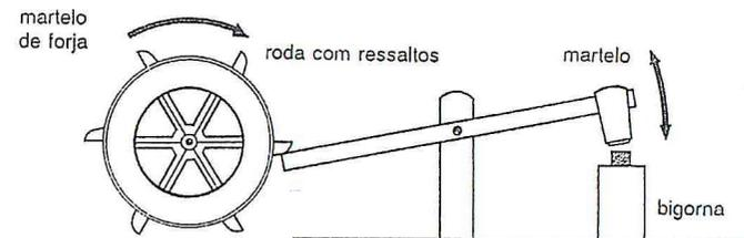
cabo (ponto fixo), de tal forma que a cabeça descansa sobre uma bigorna. O outro extremo do cabo é periodicamente empurrado para baixo e depois libertado pelas unhas de uma roda impulsora, que, na realidade, é um excêntrico. Estes martelos foram amplamente utilizados nas fundições nos começos da revolução industrial e eram habitualmente movidos por rodas hidráulicas. Um bom exemplo pode ainda ser visto nas fundições Finch, em Sticklepath, Devon.
