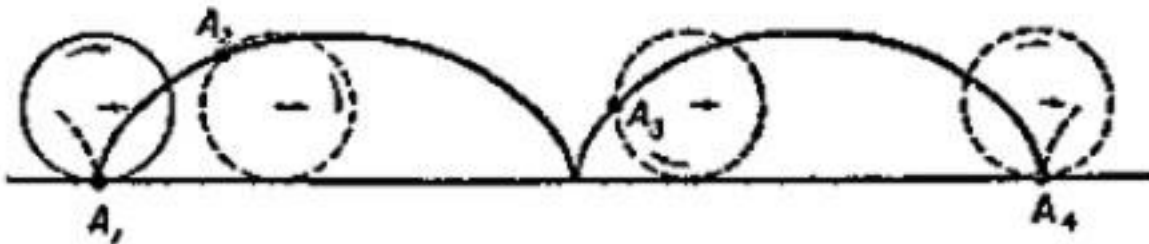
Figura 129. Cicloide, es la trayectoria descrita por el punto A, del disco que gira sin deslizamiento sobre la línea recta
