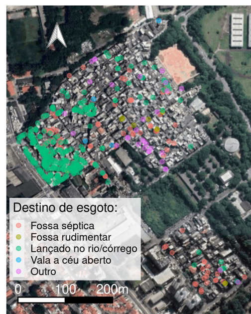
Figura 18 - Destino do esgoto entre os domicílios desatendidos pela rede de esgoto da SABESP 2
