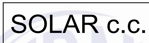
Figura A.1 – Exemplo de sinalização exigida em caixas de junção
