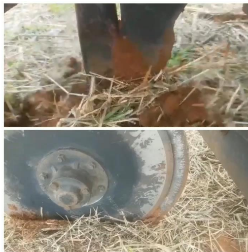
Disco Duplo e Haste Sulcadora - (Julio Pereira, UNESP)
