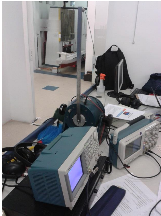
Figura 2.1 – Montagem do experimento de análise modal da barra
