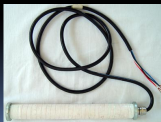
Extensômetro de estrutura
