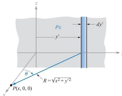
Nesta figura, temos um plano de cargas no plano  $yz$ , um ponto  $P$  no eixo  $x$ , e uma faixa de carga diferencial (largura  $dy$ ) usada para determinar o campo em  $P$ , dada por  $d\mathbf{E} = \frac{\rho_s dy \mathbf{a}_r}{2\pi\epsilon_0 r}$ .
