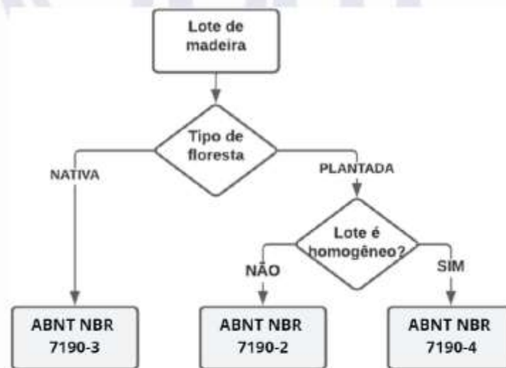
Figura 1 – Fluxograma de caracterização das propriedades de resistência e rigidez das madeiras
