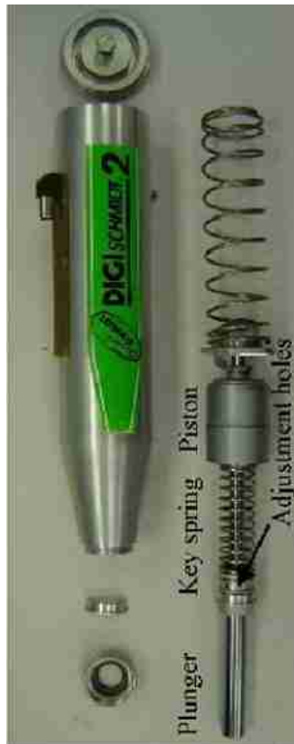
Princípio de funcionamento do martelo Schmidt
