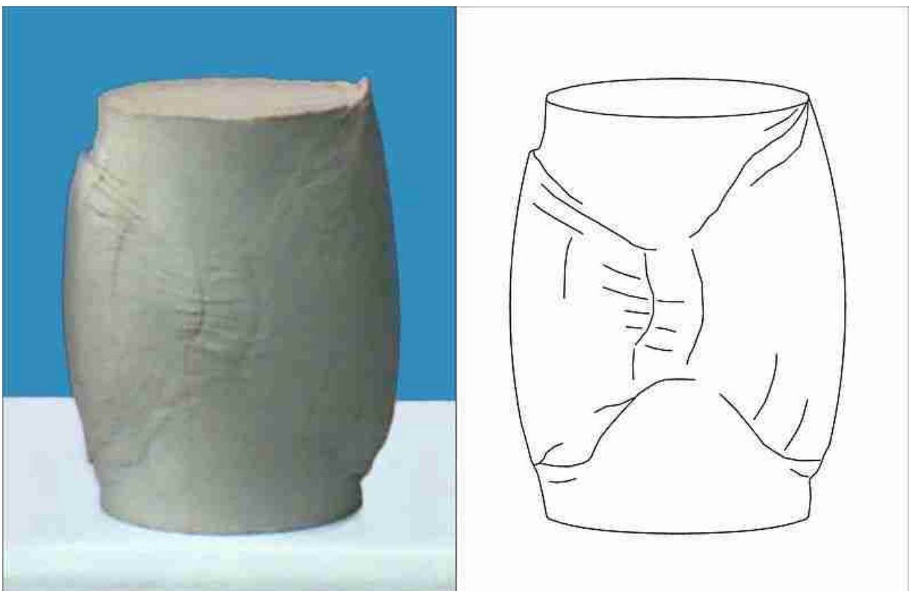
Ruptura em amostra de argila a partir de esforços de cisalhamento
