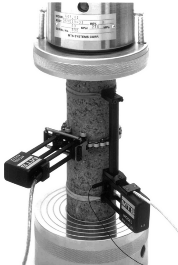
Ensaio de compressão uniaxial em prensa hidráulica
