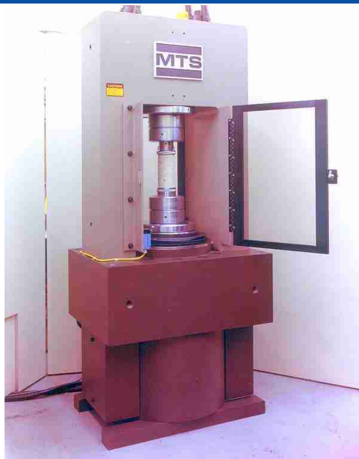
Prensa hidráulica para a realização de ensaios mecânicos em rocha
