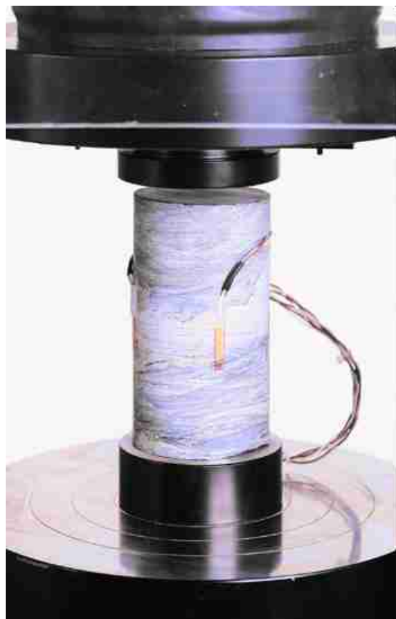
Ensaio de compressão uniaxial em prensa hidráulica
