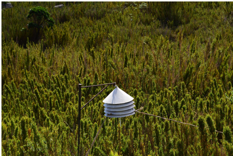
Figura 18 - Abrigo com haste, em Alto do Caparaó, MG (Yasmin Carneiro, 2023)
