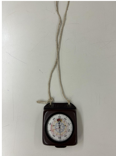
Figura 11 - Altímetro barométrico, em Laboratório de Climatologia e Biogeografia da USP-SP (Carlos Faggian, 2023)
