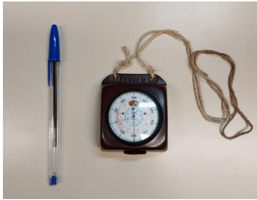
Figura 11: Altímetro Barométrico. Foto autoral tirada no Laboratório de Climatologia e Biogeografia (LCB) do Departamento de Geografia da Universidade de São Paulo, 15/06/2023.
