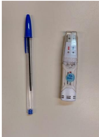
Figura 13: Datalogger HT500. Foto autoral tirada no Laboratório de Climatologia e Biogeografia (LCB) do Departamento de Geografia da Universidade de São Paulo, 15/06/2023.
