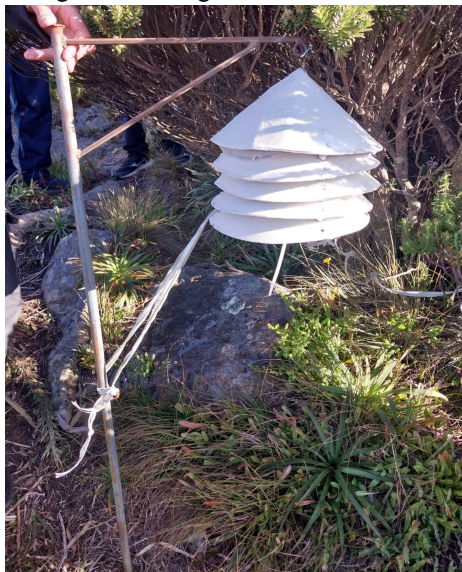
Figura 7: Mini abrigo meteorológico de baixo custo instalado no ponto 8
