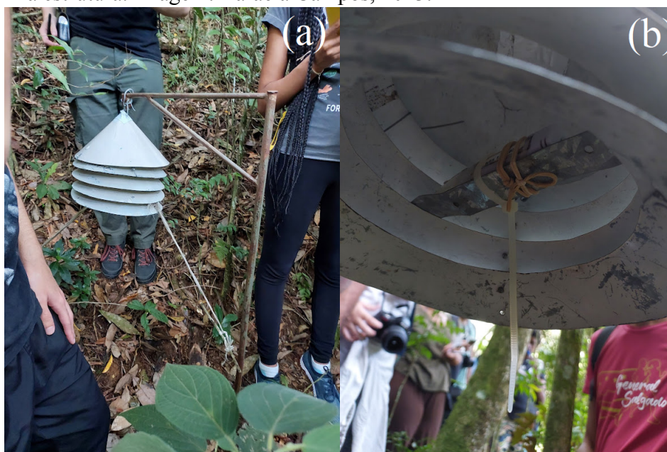
Figura 13: Posto microclimático nº 2 (P2), instalado na entrada do Parque Estadual do Caparaó pelo presente grupo. Fotografia (a) mostra sua estrutura, e (b) a posição do datalogger na estrutura. Imagem: Rafaela Campos, 2023.
