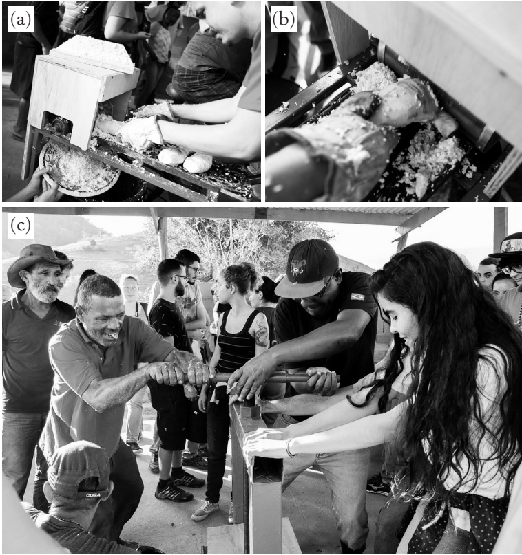
Figura 6.6 – (a) Triturador funcionando pela primeira vez; (b) Aipim sendo triturado no triturador movido a bicicleta; (c) Prensa funcionando pela primeira vez.
