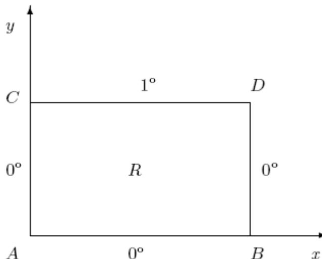
A temperatura ao longo de AB, AC, BD é mantida constante e igual a 0°C, enquanto que ao longo de CD ela é igual a 1°C. A distribuição do calor na barra R obedece à seguinte equação:
