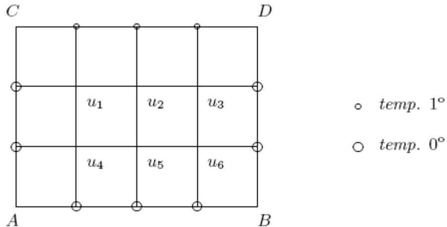
Nessa figura estamos considerando  $h = k = 1$ . A temperatura  $u$  nos pontos internos pode ser obtida numericamente simulando as derivadas segundas da Eq. (1), pelas diferenças de segunda ordem  $\Delta^2 u$  de modo que para  $h = k$ , obtemos:
