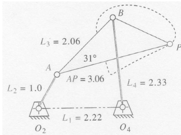
Resp.:  $\dot{\theta}_{AB} = -0,37 \text{ rad/s}$ ,  $\dot{\theta}_{OB} = 0,16 \text{ rad/s}$ ,  $\vec{v}_P = \begin{pmatrix} -0,6 \\ -0,6 \\ 0 \end{pmatrix} \text{ m/s}$
