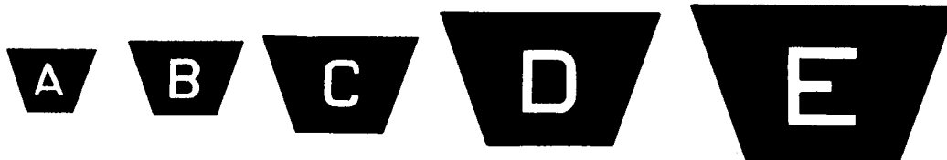
Figura 4.2 Perfis de correia trapezoidal [Goodyear]
