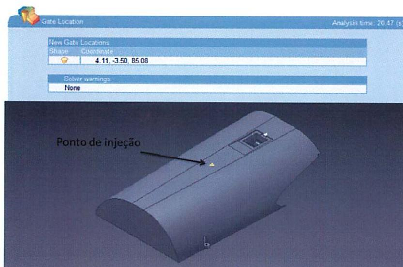
Figura 19.1. Determinação do ponto de injeção.
